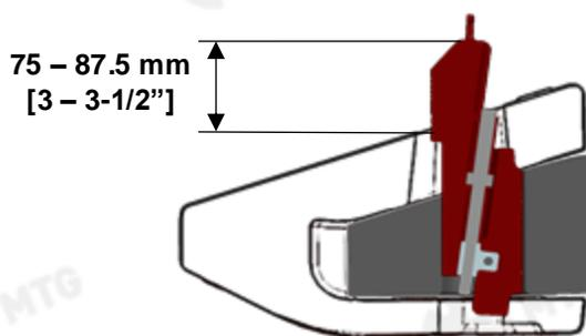
**2.5** Após a instalação, se uma porção da Cunha ficar muito para baixo do protetor (chanfro sob o protetor), isto significa que o lábio está desgastado e necessita ser recalibrado.
