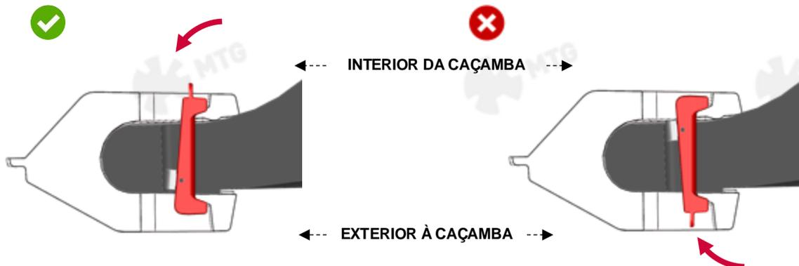
**2.3** Monte o Parafuso dentro da Cunha conforme mostrado na figura abaixo e em seguida insira a Cunha com o Parafuso em seu alojamento de forma o Parafuso esteja concêntrico com o bloco rosqueado do Grampo C (*C-clamp*) e **aperte com uma parafusadeira de impacto com um torque de 540 Nm (400 lb-ft)**. Para o aperto utilize uma soquete sextavada de impacto 19 mm.
