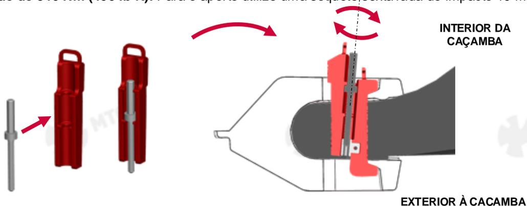
**2.4** Após a instalação, uma vez que a Cunha esteja em sua posição final, sua altura máxima acima do protetor deve estar entre 75 e 87,5 mm (3 e 3-1/2"). Caso a cunha ultrapasse esta dimensão a montagem não é satisfatória, a estação do protetor não está calibrada corretamente e deve ser reparada.
