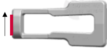
PRIMEIRO CORDÃO DE SOLDA
