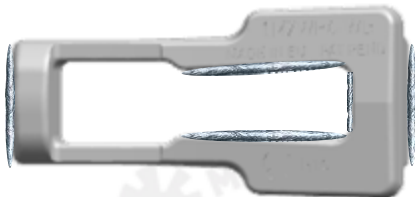
INSUFICIÊNCIA DE SOLDA
