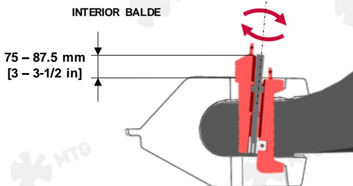
**2.5** Después de la instalación, si la cuña está alineada con el c-clamp por el exterior, se debe instalar la cuña 2. Si la cuña 2 tiene la misma condición, esto significa que el labio debe reconstruirse.
