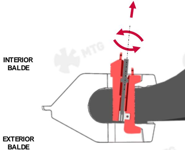
**3.3** Una vez retirada la cuña, el C-clamp queda liberado, entonces el anclaje esta fuera y el protector puede ser retirado.
