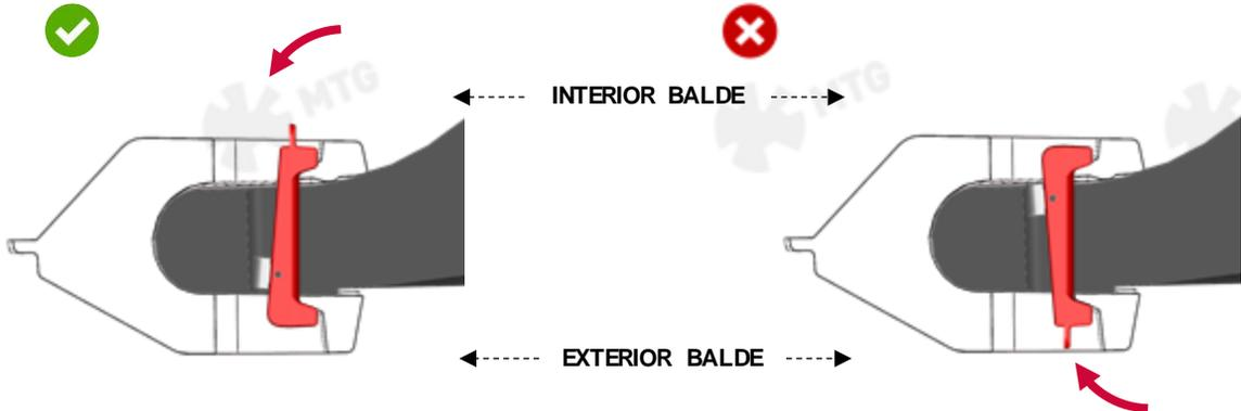
**2.3** Colocar el perno dentro de la cuña como muestra la figura, introducir la cuña en su alojamiento desde el interior del balde y apretar el perno mediante pistola de impacto con un par de 540 Nm (400 lb-ft). Tamaño del vaso de impacto hex. 19mm (3/4").
