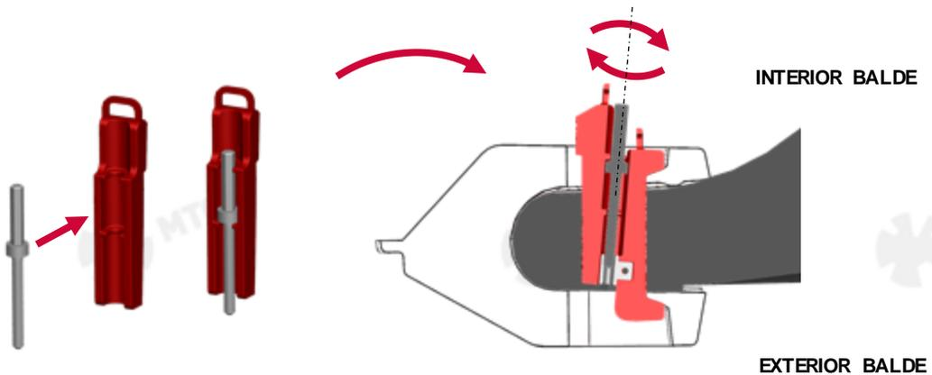
**2.4** La longitud máxima permitida que la cuña puede sobresalir del protector es de entre 75 y 87.5mm [3" y 3-1/2"]. Si la cuña sobresale más de esta dimensión, la estación del protector no está calibrada correctamente y debe repararse.
