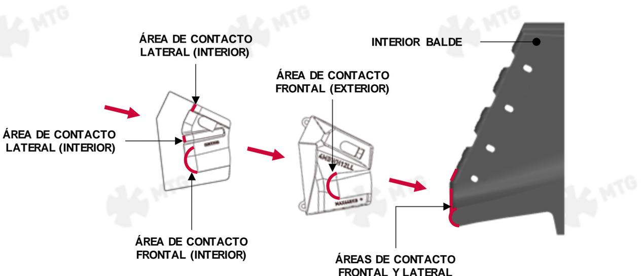
**2.2** Colocar el C-Clamp en su posición. Introducirlo siempre con la argolla desde el **interior del balde**.
