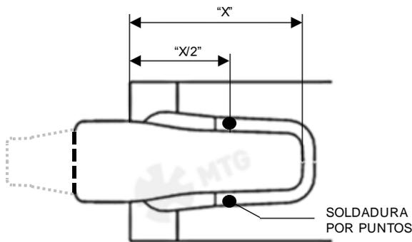
**5.1.3** Empezar la soldadura en el centro de la pala superior y darle continuidad al cordón hasta el punto medio del otro extremo de la pala.
