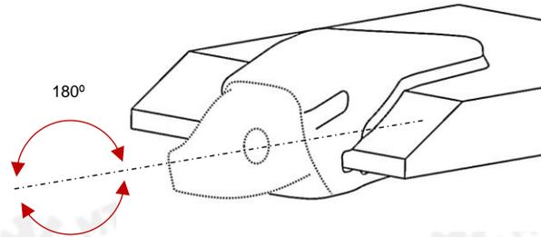
**5.1.8** Iniciar la soldadura de la pala inferior desde la parte frontal del labio (bisel) y avanzar hacia el punto medio de la parte trasera. Iniciar la soldadura respetando la distancia "d1" según lo indicado en el punto 5.1.4
