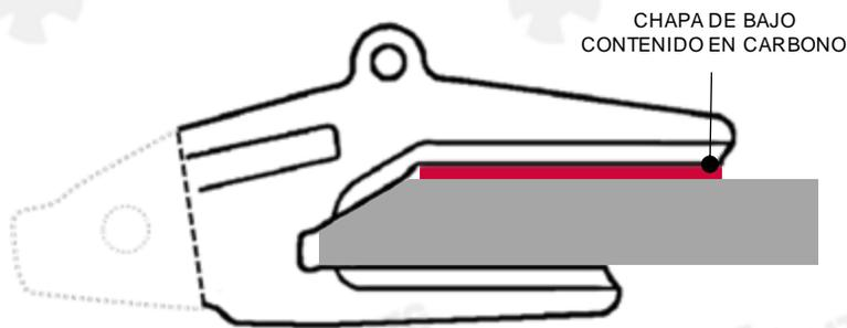
4.1.3 Alternativamente el espacio resultante puede ser reducido mediante soldadura en la pala superior del adaptador tal y como se indica a continuación:
