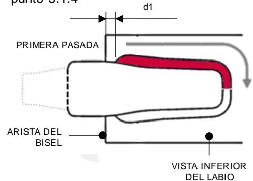
**5.1.9** Repetir el paso anterior en el lado opuesto de la pala uniendo ambas soldaduras de la pala inferior.
