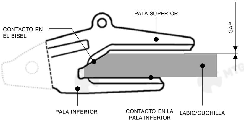
4.1.2 En el caso de que el espaciado sea mayor, añadir una plancha metálica de bajo contenido en carbono entre la pala superior del adaptador y la cuchilla para reducirlo.
