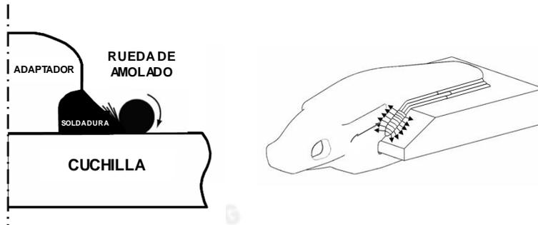
La dirección de amolado ha de ser perpendicular a los extremos de los cordones de soldadura como se muestra en la figura.
