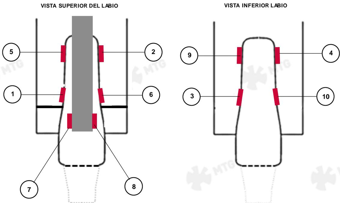
**5.2.4** Comenzar a soldar el adaptador al lateral del balde. Soldar el lado interno del lateral del cazo con una pasada rodeando el borde hasta la parte posterior del adaptador, luego soldar el lado externo desde el comienzo de la pasada anterior hasta la parte posterior del adaptador.
