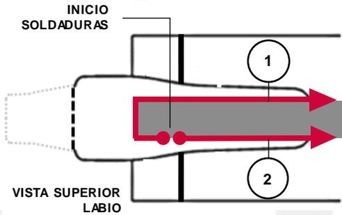
**5.2.5** Soldar el lado interior del adaptador al labio con una pasada, teniendo en cuenta la distancia "d1" vista en el punto 5.1.4, luego aplicar una segunda pasada de la misma manera en el lado exterior del adaptador.
