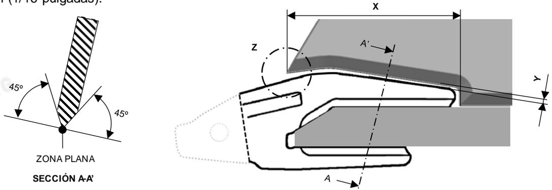
**5.2.2** Precalentar cuchilla, adaptador y lateral del cazo a una temperatura entre 175°C / 347°F y 200°C / 392°F dentro de una distancia de 100mm (4 ") alrededor de las zonas a soldar de acuerdo con lo expuesto en el documento titulado "Recomendaciones generales de soldadura". No sobrepasar los 250°C / 480°F.
