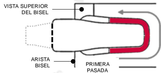
**5.1.4** En el lado de la soldadura inicial, soldar desde la parte frontal (bisel) hasta el punto inicial de la primera pasada. Iniciar la soldadura respetando la distancia "d1" desde el frontal de la cuchilla, según lo indicado en la tabla inferior.
