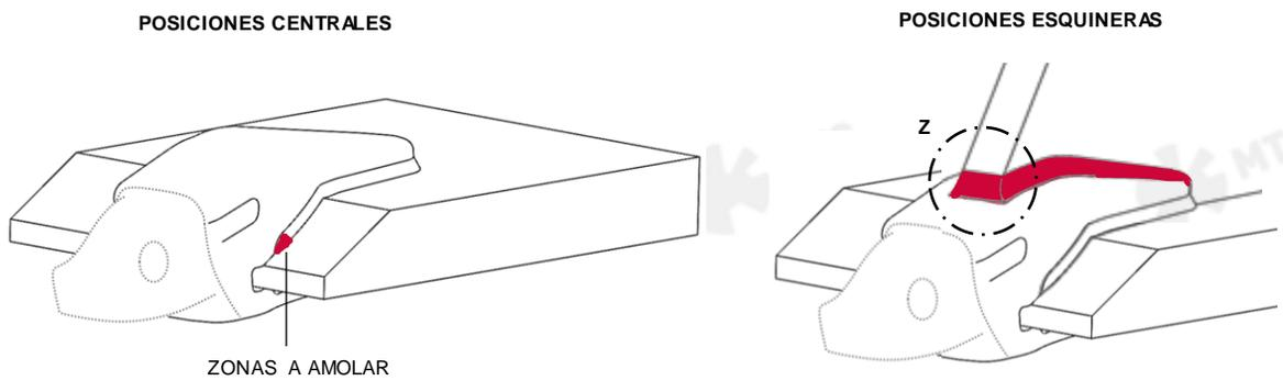
**5.3.3** Tras el amolado la superficie ha de estar libre de zonas rugosas y ondulaciones asociadas a la disposición de los cordones de soldadura. El borde de la soldadura ha de estar unido de forma regular y progresiva al labio y al adaptador con un radio mínimo de 4mm (5/32”).
